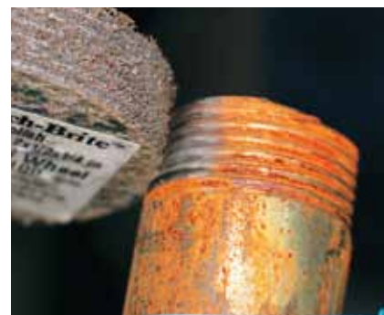
Čiščenje rje z navojev
