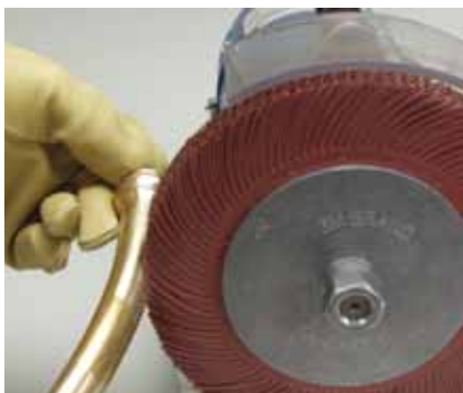
Čiščenje in obnova površine
