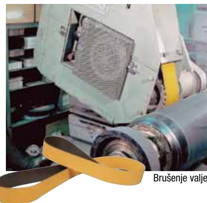
Brušenje in obnova tovarniških zarez
