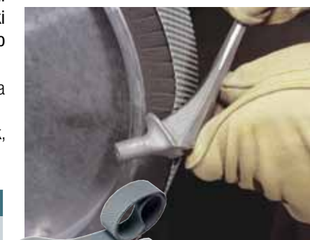
Natančno brušenje litih izdelkov
