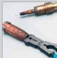
Čiščenje brizganih delčkov s čelne strani zunanje šobe.
