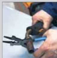
Demontaža in montaža šobe.
