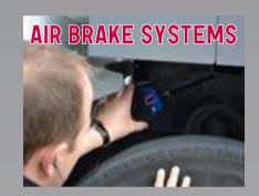
**ULTRASONIC LEAK DETECTOR**
