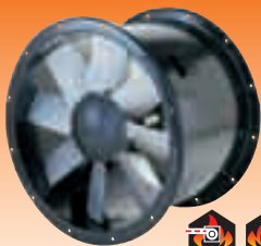
Ventilatori assiali intubati per estrazione fumi d'incendio, certificati per funzionamento 2h a 400°C. Ducted axial fan for fire fumes extraction, certified for 2 h operation at 400°C.
