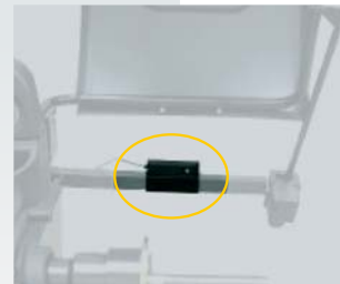
GAR 214 (ER/ERP 240 - 250 265 - 270) Dispositivo di misura elettronica del run-out (eccentricità) Electronic device for run-out measurement Vorrichtung zur Vermessung der Radunrundheit (run-out)
